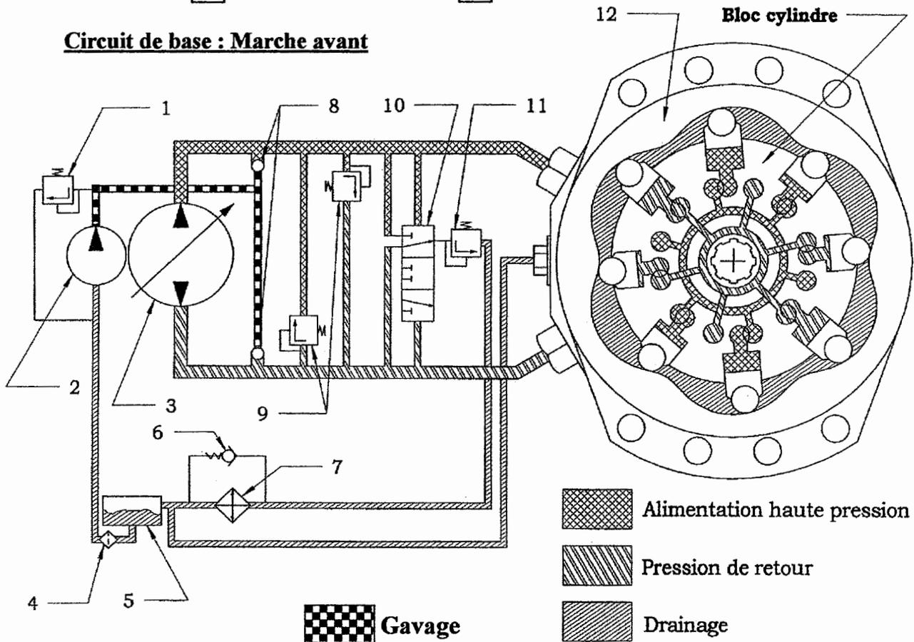
b - A partir du schéma ci-dessus compléter la nomenclature du circuit de base de la transmission hydrostatique donnée ci-dessous.
