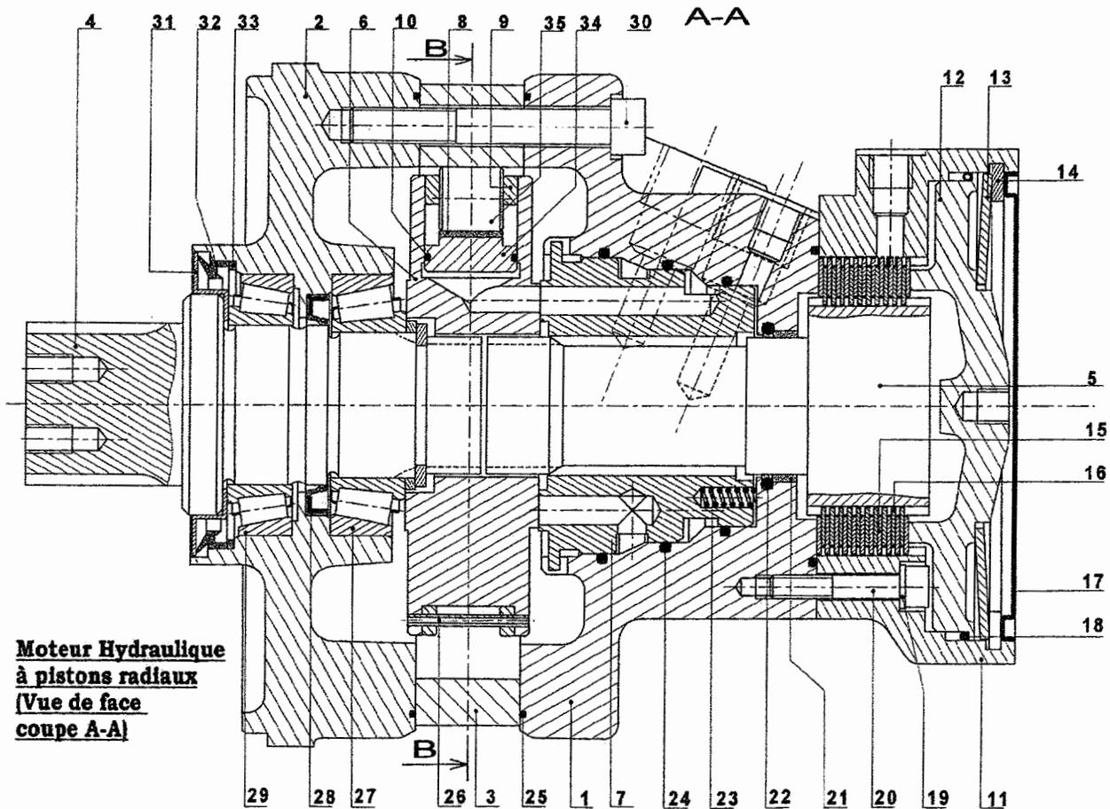
**Moteur Hydraulique à pistons radiaux**
